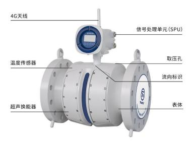
图 3 流量计结构图
