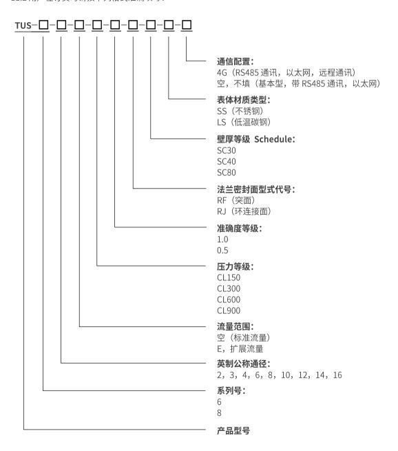
例如,用户需要高压超声: ①高压气体超声流量计; ②6 系列; ③内径为 80; ④按标准流量; ⑤压力等级 Class600; ⑥准确度等级 1.0; ⑦凸面法兰密封面; ⑧壁厚等级 Schedule40; ⑨表体材质为低温碳钢; ⑩4G 无线远传通讯; 则选型时填写如下:
